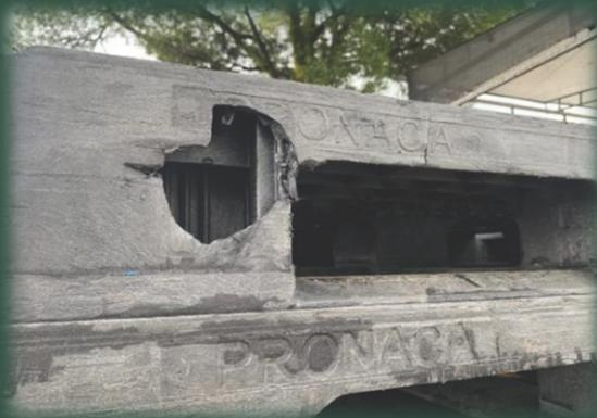
EN ESTOS 3 CASOS, LA ESTRUCTURA DEL PALLET SE VE AFECTADA Y LA CAPACIDAD DE CARGA NO ES IGUAL A LA DE UN PALLET SIN FRACTURAS.
